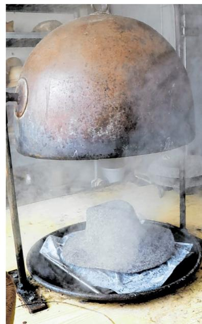
Immer wieder muss das Material in der Dampf-glocke auf 100 Grad erhitzt werden. Durch die Hitze kann er in Form gezogen werden.
