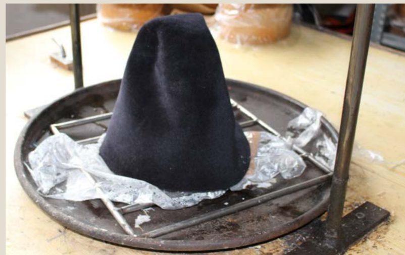
Unter der heißen Dampflocke formbar gemacht, wird der Stumpen aus schwarzem Velour dann über die Holzform gezogen.
